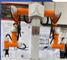
डुअल आर्म मैनिपुलेटर (डीएम) : पात्र के अंदर रिमोट हैंडलिंग कार्यों के लिए विकसित किया गया दो भुजाओं वाला एक रोबोटिक मैनिपुलेटर
