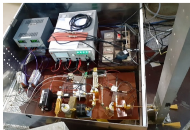
चित्र A.3.11: योजनाबद्ध ब्लॉक आरेख और 100 गीगाहर्ट्ज (GHz) हेटेरोडाइन प्रणाली।
