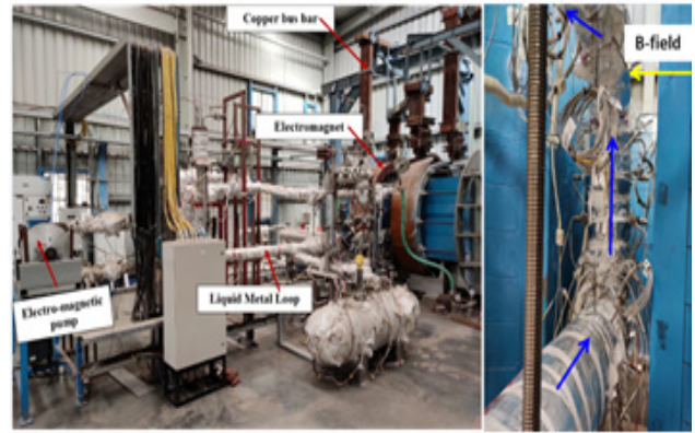
चित्र A.4.6: संस्थान में Pb-Li एमएचडी लूप (बाएं) और चुंबक पोल गैप (दाएं) के अंदर 'यू' आकार का सर्कुलर क्रॉस-सेक्शन परीक्षण।
