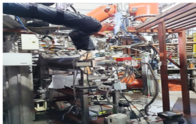
चित्र A.4.13: एसएसटी-1 टोकामैक के रेडियल पोर्ट पर सोरप्शन पंप स्थापित किया गया है।
