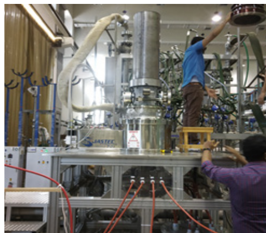
चित्र A.4.25: संस्थान की इटर-भारत प्रयोगशाला में जाइरोट्रॉन का परीक्षण।
