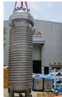
चित्र B.1.3: परीक्षण के अधीन पूल स्क्रबर टैंक पीएसटी लिफ्टिंग और उत्पादक की साइट पर शिपिंग के लिए पैक किया गया।
