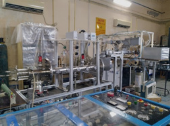
चित्र A.2.23: एचपीएम - 3 MW, 3 GHz स्पंदित मैग्नेट्रोन स्रोत के साथ 100 mm प्लाज़्मा कॉलम के साथ प्लाज़्मा युग्मन सेट-अप।
